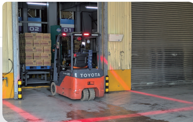
▲ 2024目標改善方案-堆高機裝設安全區域警示燈 建立一高辨識區域，提醒安全距離
