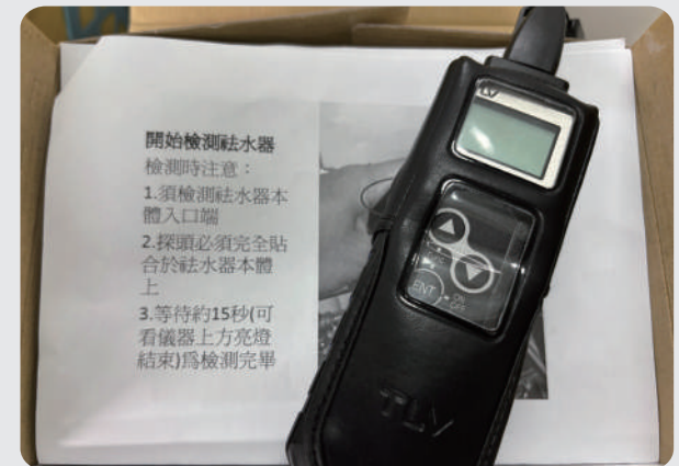
▶ 新增及加強更新管路及設備保溫，導入却水器定期量測抓漏機制
